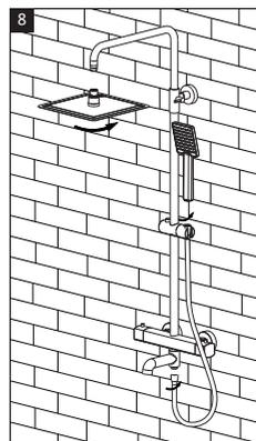
1. Заполните пространство между стеной и водопроводными розетками силиконом. Откройте главный кран подачи воды для промывки труб.
