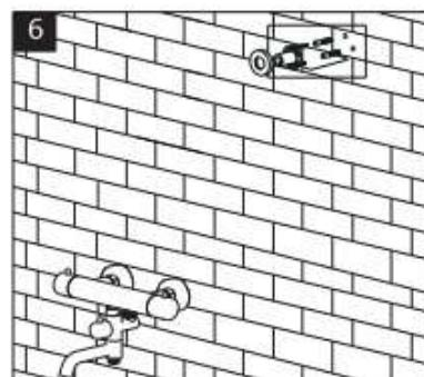
1. Riempire lo spazio tra il muro e i raccordi curvi con flangia con silicone. Aprire la volvola principale di alimentazione dell'acqua a risciacquare i tubi.
