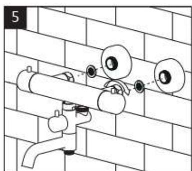
1. Заполните пространство между стеной и водопроводными розетками силиконом.
